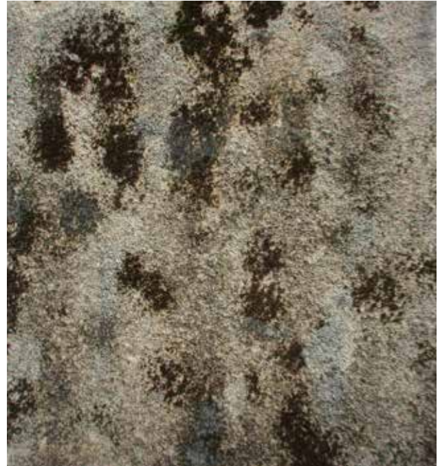
Bild 7: Massiver Moosbewuchs an einem WDVS-Prüfkörper. An den unterschiedlichen Farbschattierungen lässt sich bereits erkennen, dass es sich um verschiedene Arten handelt; grau: Mauer-Drehzahnmoos ( Tortula muralis ), schwarz: verschiedene Arten der Spalthütchen-Moose ( Schistidium spp.). [© Fraunhofer-Institut für Bauphysik Holzkirchen]
